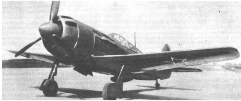
Летом 1946 года прошел испытания самолет **ЛА-9**. ЛА-9 первый цельнометаллический истребитель конструкции **С.А.Лавочкина**. Серийное производство ЛА-9 продолжалось в Горьком с 1946 по 1948 год.
