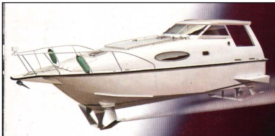
В **1993** году фирмой «ТРАНСАЛ-АКС» был разработан эскизный проект морского прогулочного катера на подводных крыльях ТА-10 «Сокол», конструкторская документация разработана ОКБ завода «Сокол» в 1994 году. В 1995 году был собран и спущен на воду первый катер.
