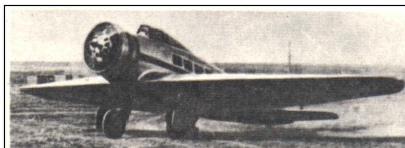
Завод осваивает самолет **ХАИ-1** в пассажирском и военном вариантах главного конструктора **И.Г.Немана**. Самолет ХАИ-1 первый в СССР скоростной 7-местный низкоплан с убираемым в полете шасси был оснащен отечественным двигателем М-22 мощностью 480 л.с. Конструкция ХАИ-1 цельнодеревянная. Заводские испытания показали, что самолет развивает скорость до 300 км/час.
