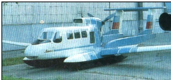
**Самолет-амфибия «Динго»** с шасси на воздушной подушке. Работа по разработке технической документации и постройке опытных самолетов «Динго» на заводе проводилась в **1993-1996 гг.** «Динго» представляет собой цельнометаллический моноплан с низко расположенным крылом, двухкилевым оперением, установленным на тонких фюзеляжных балках, и прямым горизонтальным оперением, расположенным на килеях.
